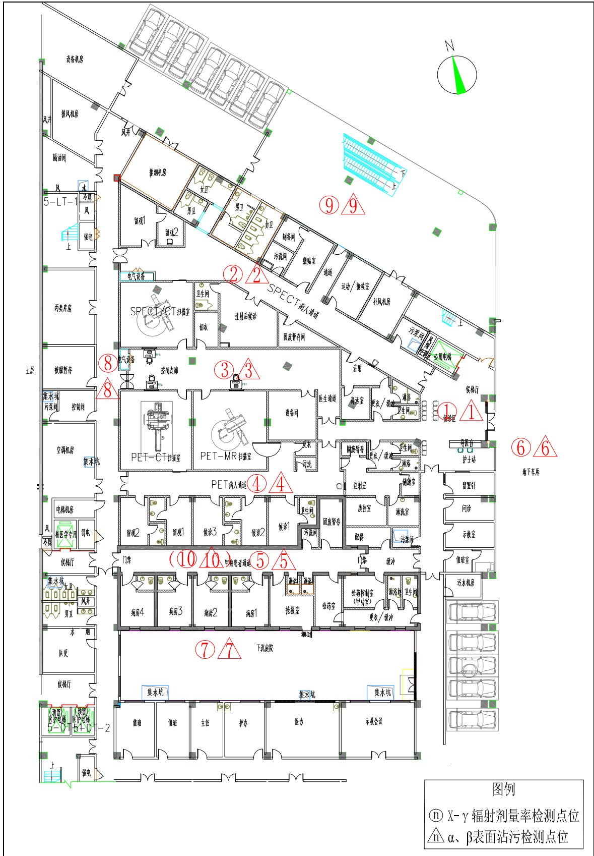
图 8-2 本项目拟建场址及周围环境 \gamma 辐射剂量率和 \alpha 、 \beta 表面沾污检测点位示意图
